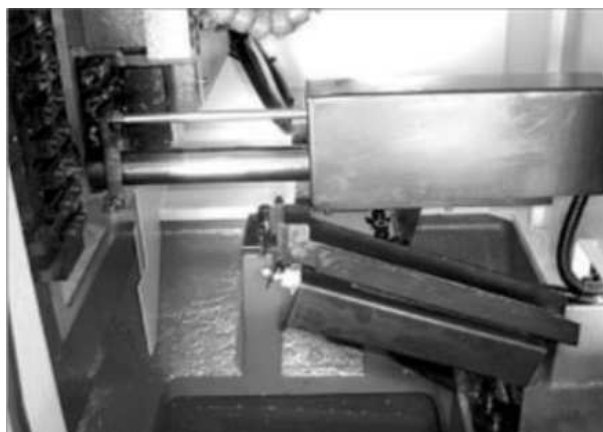
Průchod dlouhých dílců proti-vřetenem
